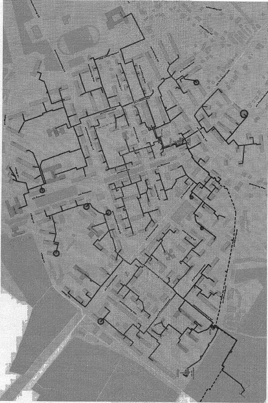
Рисунок 1.7. Схема тепловых сетей системы отопления г. Новоульяновск со сроком службы более 30 лет
